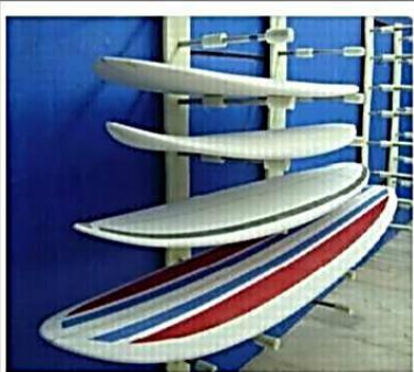
用玻璃纤维制成的冲浪板，比木质板更轻，且易于制成各种形状
